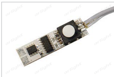
013210 12V для PDS с проводом 1.5м
