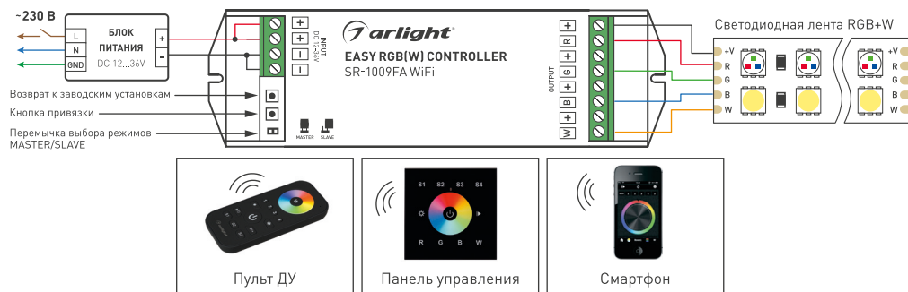
Рисунок 1. Схема подключения и варианты управления контроллером.
